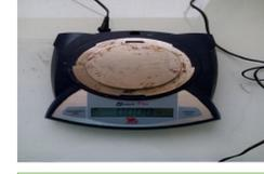
Figure 3: balance de précision au 1/10000
